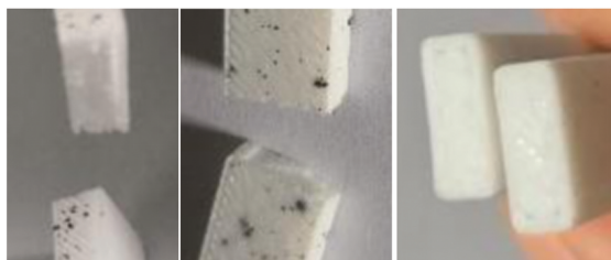
图 6 3 种试样拉伸断面图(由左到右依次为:侧立式,平躺式,站立式)
